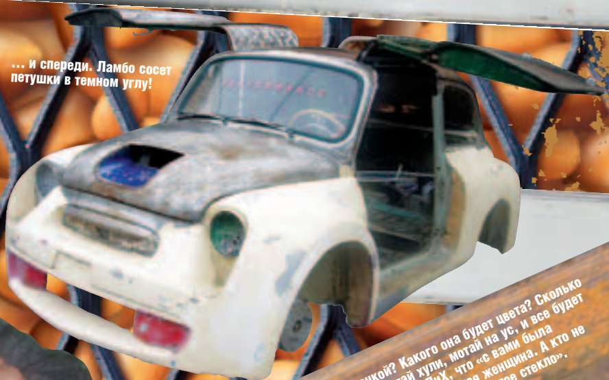
Чтобы двери держались в вертикальном положении, их надо чем-то удерживать. В нашем случае это делают спаренные гидравлические стойки, опирающиеся на шарнир, который прикручен к кривоку, приваренному к двери. О как.
